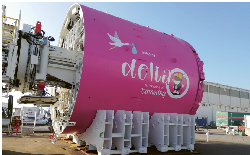
TBM per lo scavo del cunicolo di accesso ad Airolo (Foto: collaudo in fabbrica a gennaio 2022).
